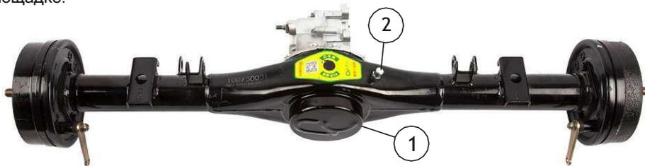
Для облегчения слива отработанной смазки из редуктора необходимо прогреть его путем поездки на в течение 10 - 15мин.
